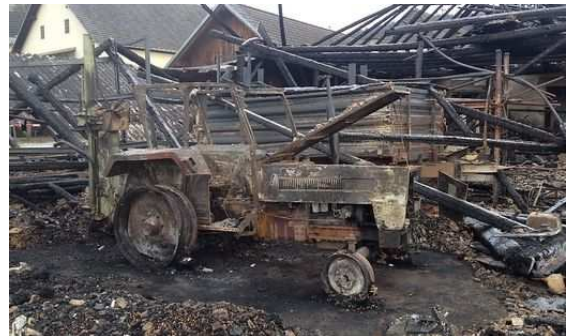
Brandursache ist Kurzschluss der Batterie eines Traktors © Privat
