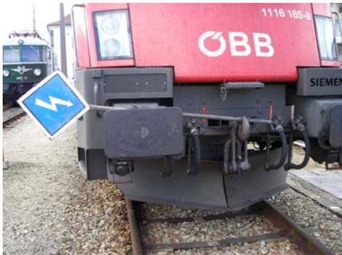
Abbildung 7.03 – Signal „An die Vorheizanlage angeschlossen“
